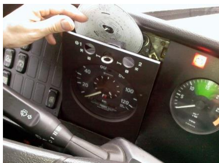
Enlèvement d'une feuille d'enregistrement dans un tachygraphe analogue lors d'un passage de frontière. 8
