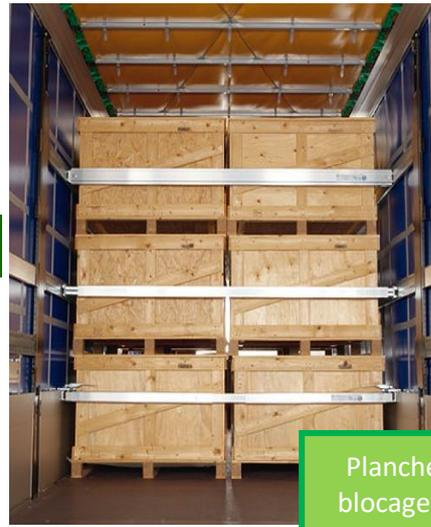
Planches / poutres de blocage pour sécuriser vers l'arrière.
