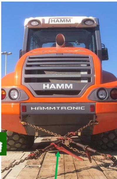
Une machine lourde est à sécuriser en arrimage direct par 4 chaînes ( 2 à l'arrière et 2 à l'avant).
