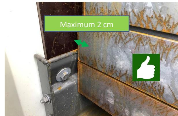
Dans le cas d'un arrimage par blocage, les écarts entre la paroi avant et les parties de chargement comme les palplanches, les poutres, les dalles en béton doivent être réduites au minimum (max. 2cm) pour éviter que le chargement fasse impact contre la paroi. **Un arrimage par blocage est la méthode la plus efficace.**
