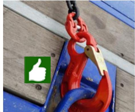
Le crochet de la chaîne doit être fixé directement au point d'arrimage.
