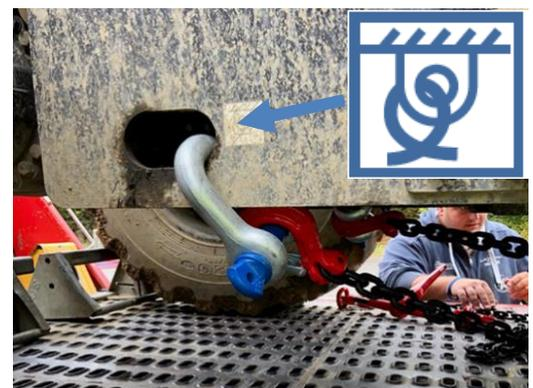
Si le crochet de la chaîne ne peut être fixé directement sur l'engin utilisez des manilles. Ces manilles existent en différentes forces. Bien évidemment, la manille doit être appropriée à la résistance du point d'arrimage choisi.
