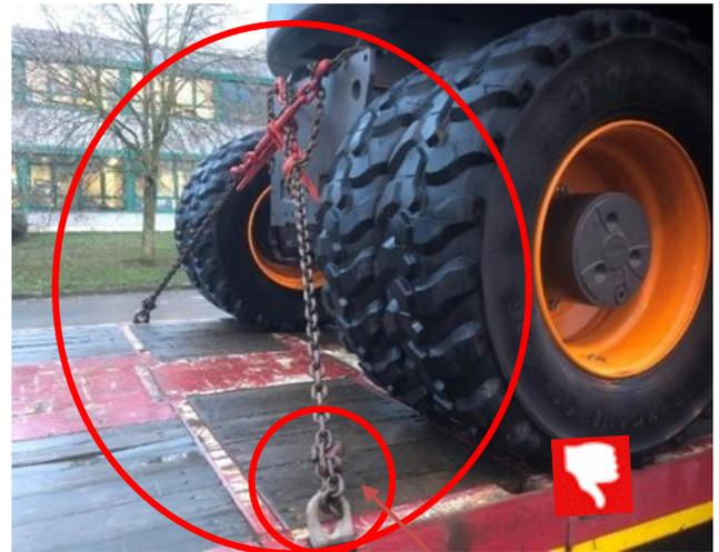
La chaîne ne doit pas être fixée à l'aide du crochet de raccourcissement.
