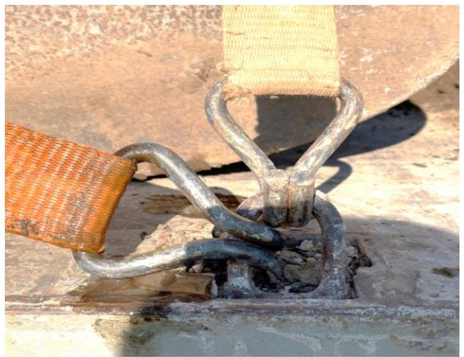
Utilisation de plusieurs crochets à un point d'arrimage. Ceci est uniquement autorisé si le point d'arrimage (+ 12t = 2000 daN) n'est pas surchargé et que les crochets des sangles soient sollicités correctement.
