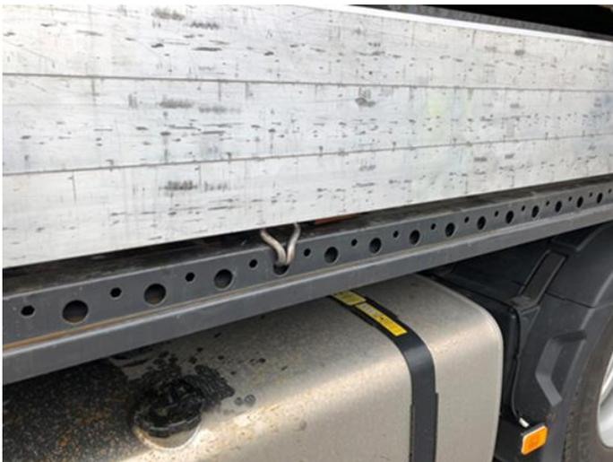
Chaque trou dans le châssis sert de point d'arrimage. 3 points d'arrimage sont utilisables sur un mètre au maximum. Chaque point d'ancrage a une capacité de 2000 daN.
