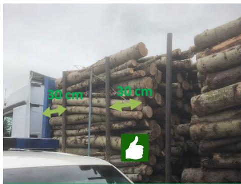
Au moins 2 paires de supports verticaux (colonnes) pour un arrimage conforme. Les extrémités du bois doivent dépasser des colonnes d'au moins 30 cm.
