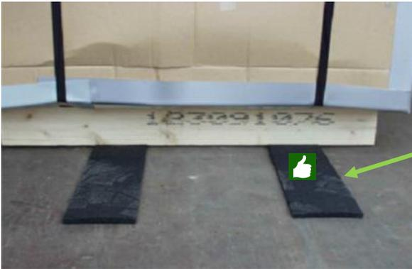
On n'a pas besoin de l'utiliser sur toute la surface à moins que le chargement et la surface de chargement ne se touchent pas. Le tapis antidérapant doit séparer le chargement du plateau pour avoir 60 % de frottement.
