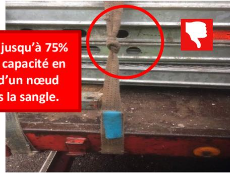
Perte jusqu'à 75% de sa capacité en cas d'un nœud dans la sangle.
