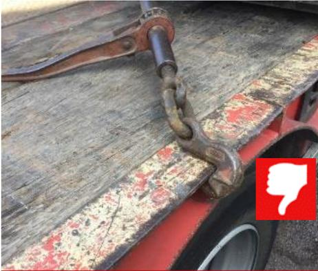
Crochet de raccourcissement attaché au châssis. À l'arrimage direct le crochet de la chaîne doit être fixé sur un point d'ancrage du véhicule.
