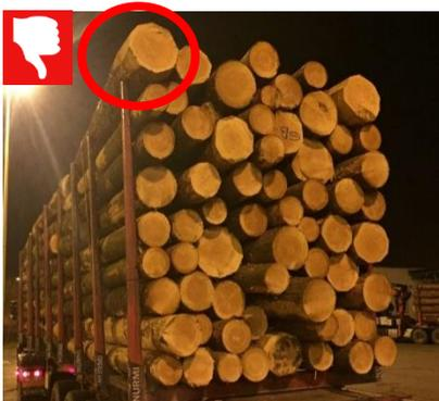
Le centre des rondins situés aux extrémités supérieures du chargement ne peut dépasser la hauteur des colonnes.
