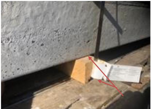
Pas de tapis antidérapant entre la surface de chargement et la poutre et aussi entre la poutre et le bloc en béton.
