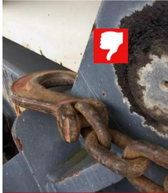
Crochet mal fixé sur la machine (Seulement sur la pointe du crochet).
